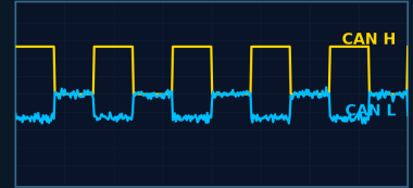
CAN H / CAN L Dengesiz Transceiver Arızası / Besleme Sorunu
