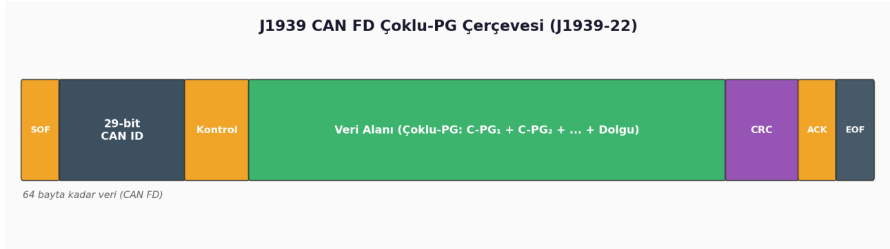
Şekil 14-1 J1939 CAN FD Çoklu-PG Çerçeve Genel Görünümü (J1939-22)
