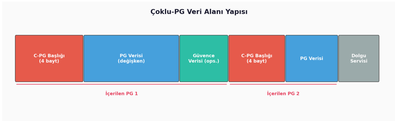
Şekil 14-2 İçerilen PG'lerle Çoklu-PG Veri Alanı Yapısı
