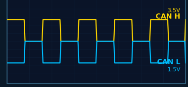
Dengeli CAN H / CAN L 3.5V / 1.5V Seviyeleri
