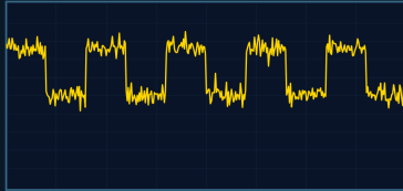
Noise EMI (Motor, İnverter) / Ekranlama Yok
