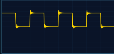
Ringing Uzun Stub / Empedans Uyumsuzluğu
